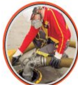
Descargue de combustible (Gasolina / Diésel)
