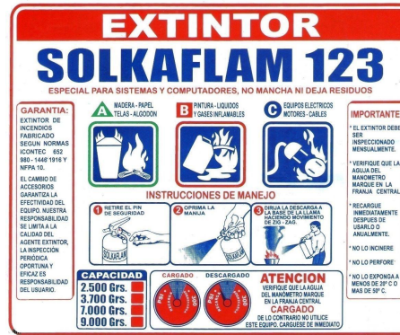
Etiqueta de instrucciones y carga de extintor
